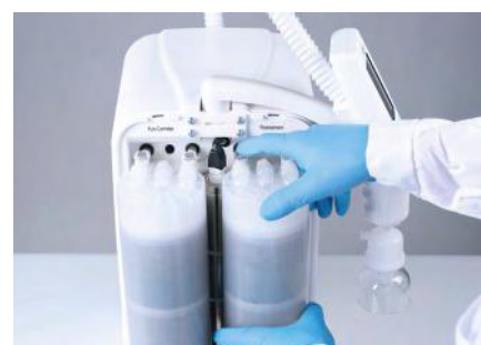
Samostatný specialista s integrovanými patronami na přečišťování vody. Jednoduchá výměna patron během několika sekund
