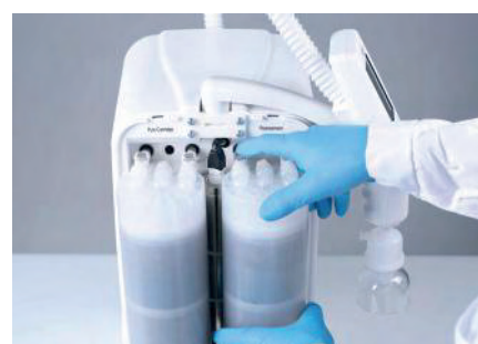
Samostatný specialista s integrovanými patronami na přechiřtování vody. Jednoduchá výměna patron během několika sekund
