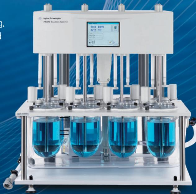
Agilent 708-DS Dissolution Apparatus
