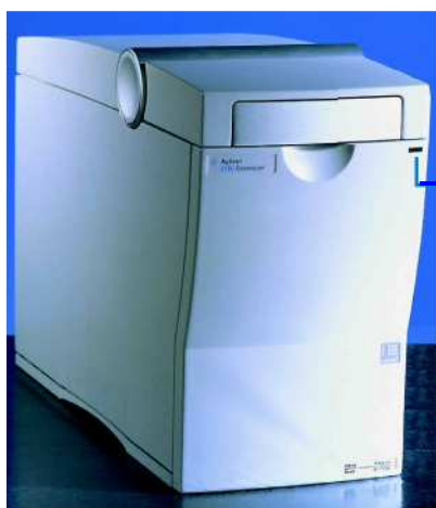
Obr. 6 Kontrolka stavu bioanalyzátoru Agilent 2100
