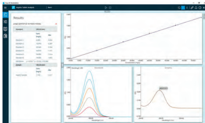
Obr. 4: Náhled softwaru cary UV Workstation ukazující kalibrační křivku a pod ní příslušné skeny standardů a vzorku
