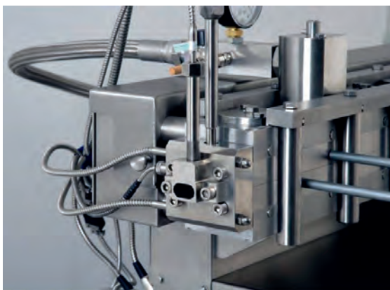
Obr. 2: Tryska pro vytlačování horké taveniny, Thermo Fisher Scientific řada Pharma 24
