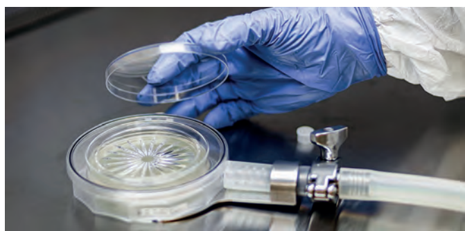
Obr. 3 – Použití BioCapt Single Use v kombinaci s mobilním aeroskopem Mincapt Mobile
