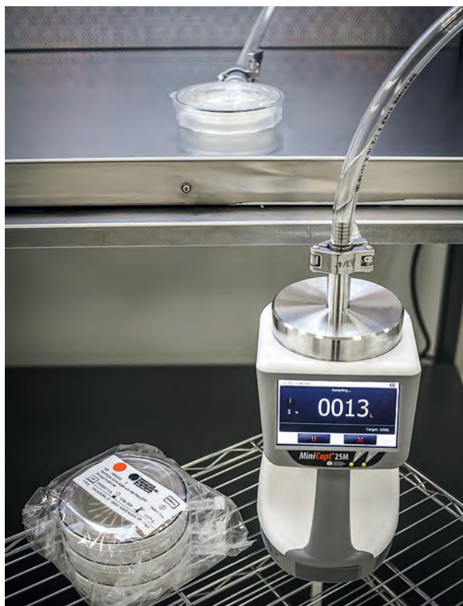
Obr. 3 – Použití BioCapt Single Use v kombinaci s mobilním aeroskopem Mincapt Mobile
