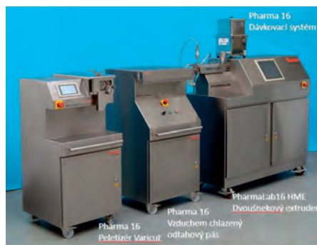
Obr. 8: Kompletní sestava Thermo Fisher Scientific Pharma 16, modularita systému
