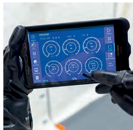
Obr. 2: Sofistikovaný řídicí software Cleamix umožňuje udržet hladinu peroxidu vodíku a vodní páry pod bodem nasycení v různých situacích biodekontaminace
