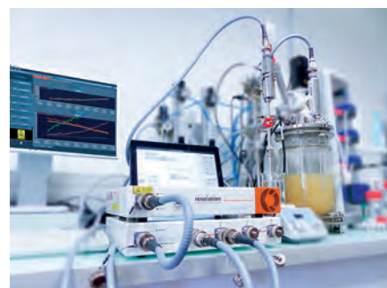
Obr.: PROCELLICSTM Ramanův analyzátor pro in-Line a real-time monitoring bioprocésů s sw ProCellicsTM
