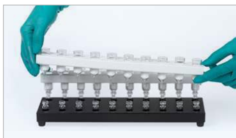
4. Odstraňte strip s TINY kolonkami ze stojánek. Naplněné kolonky se mohou použít pro další analýzy.
