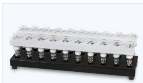
2. Na otvory vialek položte strip s TINY kolonkami.
