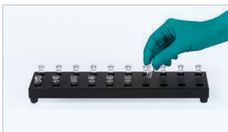
1. Vložte vialky do stojánek TINY-GC-VIAL.
